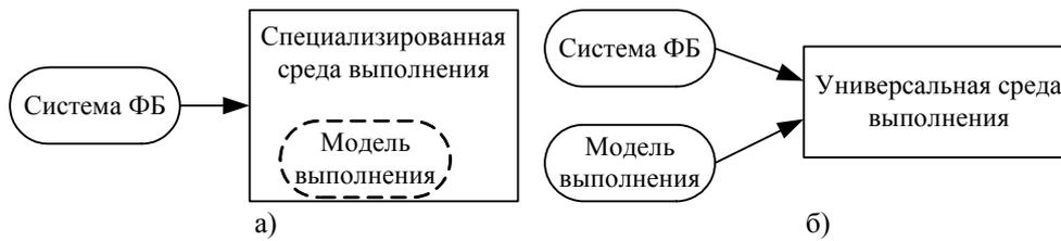
Рис. 1. Подходы к реализации систем управления на основе ФБ
